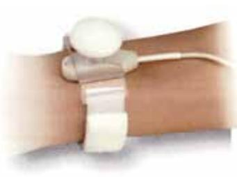
Cinta de velcro para fijación de electrodo E.M.G.
